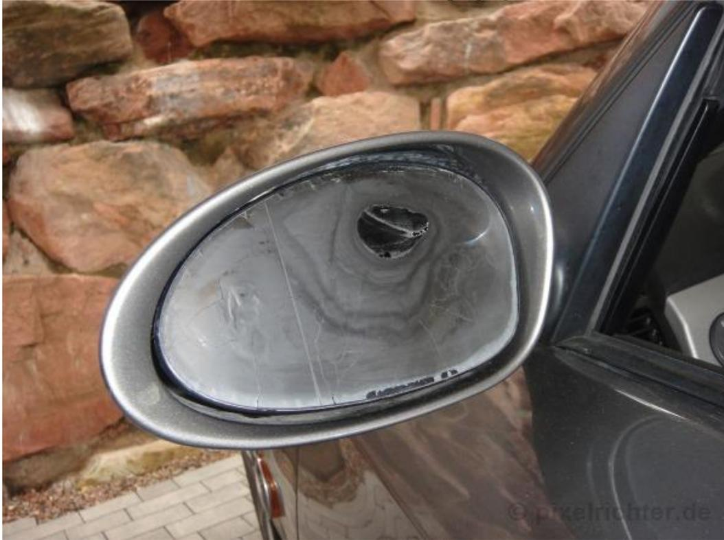
Mit Hilfe eines Fettlösesprays habe ich die Rückseite des Spiegels und der Folie gereinigt. Geklebt wurde mit MS Polymer, -40°C bis +100°C beständig. Kleben, montieren, dichten von der Fa. UHU, Artikel Nr. 47820- Der Kleber ist eine ganze Weile verarbeitbar, somit kann das Spiegelglas problemlos ausgerichtet werden. Einfach drücken und schieben, bis das Glas passt.
