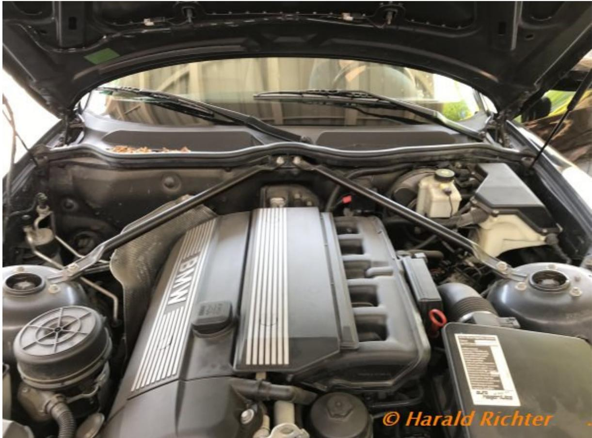
Die Scheibenwischer müssen runter, dazu die Kappen am Scheibenwischer entfernen
