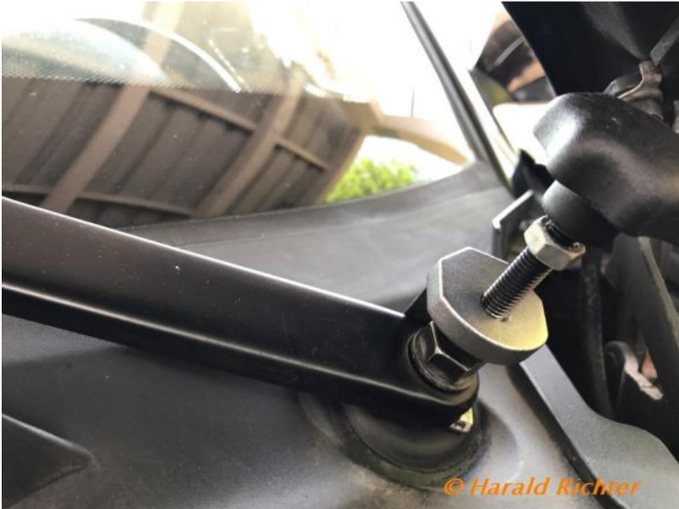
Der Abzieher wird unter den Wischerarm gesteckt, die Führung in die Mutter gesteckt und dann wird zugeschraubt. Der Scheibenwischerabzieher löst dann den Wischerarm ab. Den Abzieher entfernen und die Mutter kpl. Entfernen. Der Scheibenwischer kann abgenommen werden.
