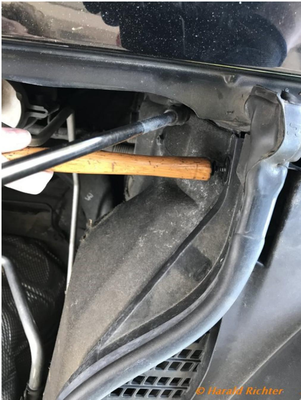
EIN Scheibenwischerarm bleibt einfachstehen oder verklemmt sich an der Außenkante Frontscheibe. Eine Reparatur ist für kleines Geld selbst durchzuführen.
