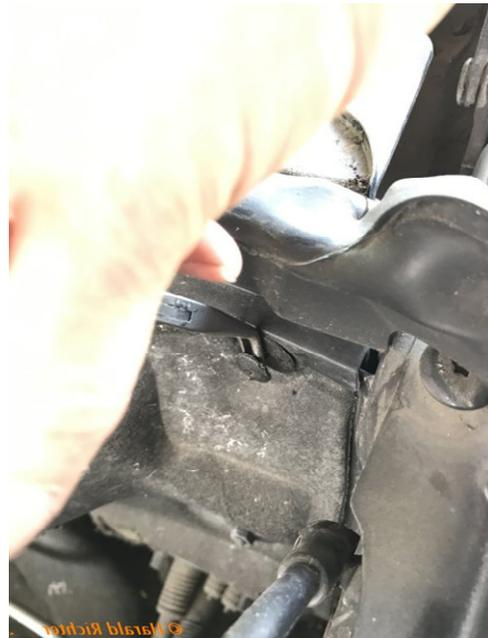
EIN Scheibenwischerarm bleibt einfachstehen oder verklemmt sich an der Außenkante Frontscheibe. Eine Reparatur ist für kleines Geld selbst durchzuführen.
