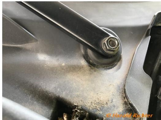
Bevor nun mit dem Scheibenwischerabzieher die Wischer gelockert werden, ist es sinnvoll, die Originalscheibenwischerstellung mittels Klebebandes (Malerkrepp) auf der Scheibe zu markieren. Geht nur an dem einen noch intaktem Arm, aber als grobe Markierung hilft es.
